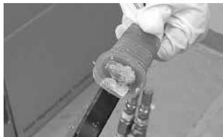
Remplacez les gicleurs fréquemment! La mousse se durcira à l'intérieur du gicleur dans le même délai que la mousse devient sèche hors-poisson dans l'air.
