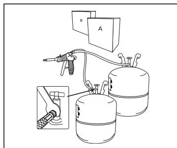
2. Conecte la manguera de código rojo al tanque del componente "A" y la manguera de código negro al tanque del componente "B", y apriete con una llave inglesa de 9/16".
