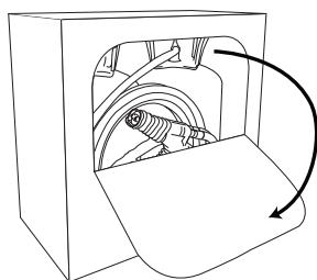
3. Presione la parte superior del panel frontal para abrir. Baje la solapa para obtener el conjunto de manguera de la unidad dosificadora. Quite el paquete de la boquilla y lea las instrucciones.
