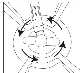
3. Abra las válvulas completamente girándolas a la IZQUIERDA. La tapa superior se puede quitar o simplemente dejar en su lugar durante el uso o almacenaje del material. Las válvulas del tanque deben estar en posición vertical durante su uso.
