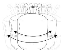
2. Agiter le kit pendant 1 à 2 minutes avant l'utilisation pour assurer un bon mélange, voir la FT pour les recommandations de mélange spécifiques à la formule. Le produit chimique doit normalement être à une température de 75 à 85° F (24 à 29° C).
