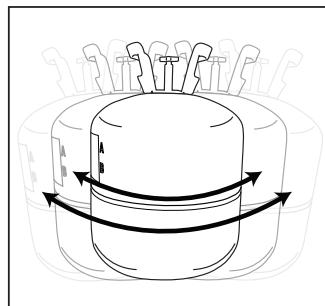
1. Agiter le kit pendant 1 à 2 minutes avant l'utilisation pour assurer un bon mélange, voir la FT pour les recommandations de mélange spécifiques à la formule. Le produit chimique doit normalement être à une température de 75 à 85° F (24 à 29° C).
