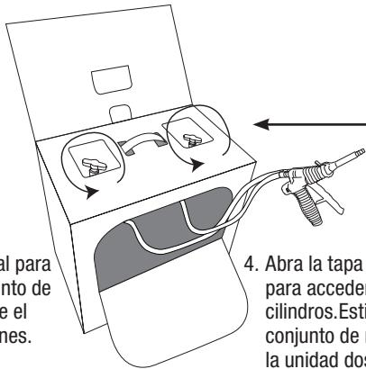
4. Abra la tapa superior de la caja para acceder a las válvulas de los cilindros. Estienda hacia afuera el conjunto de manguera acoplado a la unidad dosificadora.
