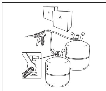
2. Visser le tuyau codé en rouge codé au réservoir de composant A et le tuyau codé noir au réservoir de composant B et serrer avec la clé de 9/16 de pouce fournie.
