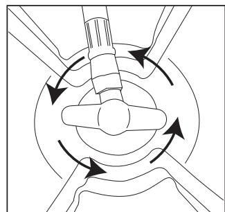
3. Ouvrir les vannes complètement en tournant les vannes DANS LE SENS CONTRAIRE DES AIGUILLES D'UNE MONTRE. Les vannes des réservoirs doivent être debout pendant l'utilisation.
