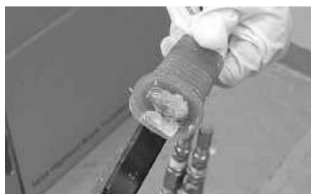
¡Cambio las boquillas con frecuencia! La espuma curará dentro de la boquilla en el mismo lapso de tiempo en que la espuma deja de ser pegajosa al aire.
