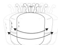
2. Agite el envase durante 1 ó 2 minutos antes del uso para asegurar que se mezcle adecuadamente; consulte la hoja de datos técnicos en cuanto a las recomendaciones específicas para la fórmula. Típicamente, la temperatura de la sustancia química debe estar entre 24 y 29°C (75 y 85°F).
