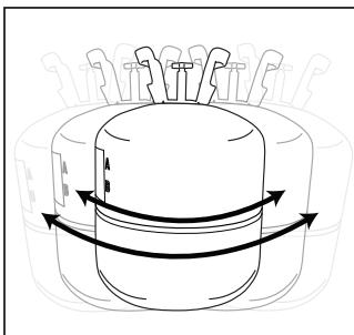
1. Agite el envase durante 1 ó 2 minutos antes del uso para asegurar que se mezcle adecuadamente; consulte la hoja de datos técnicos en cuanto a las recomendaciones específicas para la fórmula. Típicamente, la temperatura de la sustancia química debe estar entre 24 y 29°C (75 y 85°F).
