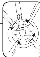
5. Ouvrir les vannes complètement en tournant les vannes DANS LE SENS CONTRAIRE DES AIGUILLES D'UNE MONTRE. Le rabat supérieur peut être enlevé ou laissé en place pendant l'utilisation ou le stockage.
