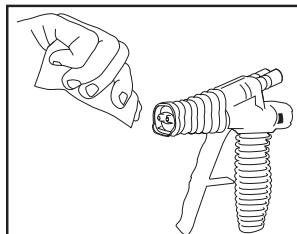
1. Avant de fixer la buse, appliquer de la vaseline sur l'embout du pistolet. Après avoir fixé la buse, pulvérisez dans le réceptacle "tir d'essai".
