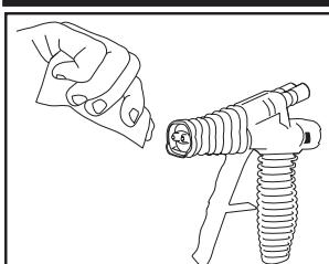
1. Antes de conectar la boquilla, aplique vaselina en la parte delantera de la pistola. Después de conectar la boquilla, atomice en un receptáculo para "disparos de prueba".
