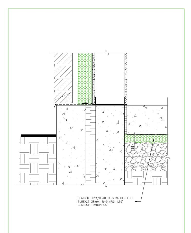
TYPICAL DETAIL - 38mm UNDER SLAB COMMERCIAL APPLICATION
