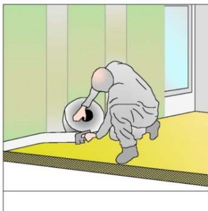
Figure 12 : Réalisation de la désolidarisation périphérique
