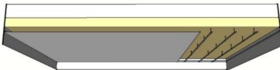
Figure 6 : Plafond constitué de fourrures et de dispositifs de suspension
