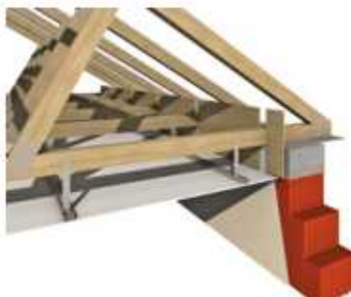
Figure 1 – Mise en place de déflecteur
