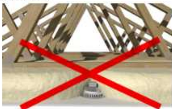
Figure 2 – Pas de matériel électrique non protégé en contact direct avec l'isolant
